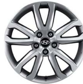
Obręcz ze stopów lekkich 18". Obręcz ze stopów lekkich z pięcioma podwójnymi szprychami, srebrna, 7.5Jx18, do opon 235/60 R18. Zestaw zawiera nakładkę i pięć nakrętek. 2WF40AC180 (modele 2012, 2015, 2016)
