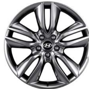
Obręcz ze stopów lekkich 19", wzór B. Obręcz ze stopów lekkich z pięcioma podwójnymi szprychami, ciemno srebrna, 7.5Jx19, do opon 235/55 R19. Zestaw zawiera nakładkę i pięć nakrętek. 2WF40AC195 (modele 2012, 2015, 2016)
