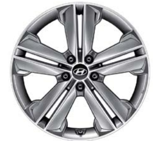
Obręcz ze stopów lekkich 19". Obręcz ze stopów lekkich z pięcioma podwójnymi szprychami, srebrna, 7.5Jx19, do opon 235/55 R19. Zestaw zawiera nakładkę i pięć nakrętek. B8F40AC195 (modele 2012, 2015, 2016)
