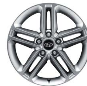
Obrazek ze stopów lekkich 17". Obrazek ze stopów lekkich z pięcioma podwójnymi szprychami, 7.0Jx17-B, do opon 235/65 R17. Zestaw zawiera nakładkę i pięć nakrętek. 2WF40AK210 (modele 2012, 2015, 2016)
