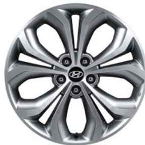
Obręcz ze stopów lekkich 19", wzór A. Obręcz ze stopów lekkich z pięcioma podwójnymi szprychami, srebrna, 7.5Jx19, do opon 235/55 R19. Zestaw zawiera nakładkę i pięć nakrętek. 2WF40AC390 (modele 2012, 2015, 2016)
